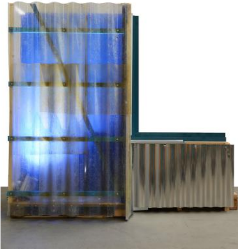
Hinterleuchtete Kunststoffpaneele schaffen eine thermisch isolierende Pufferschicht.
